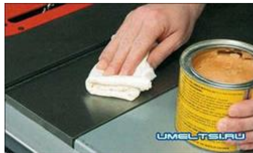
Рис.2. Нанесение специального покрытия для защиты от коррозии [3, С.10]
